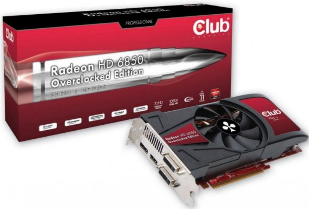
Club3D ha annunciato la nuova Radeon HD 6850 1GB Overclocked Edition che si presenta con un dissipatore modificato rispetto alla versione reference, dotato di due coppie di heatpipes e di ventola da 92mm.
