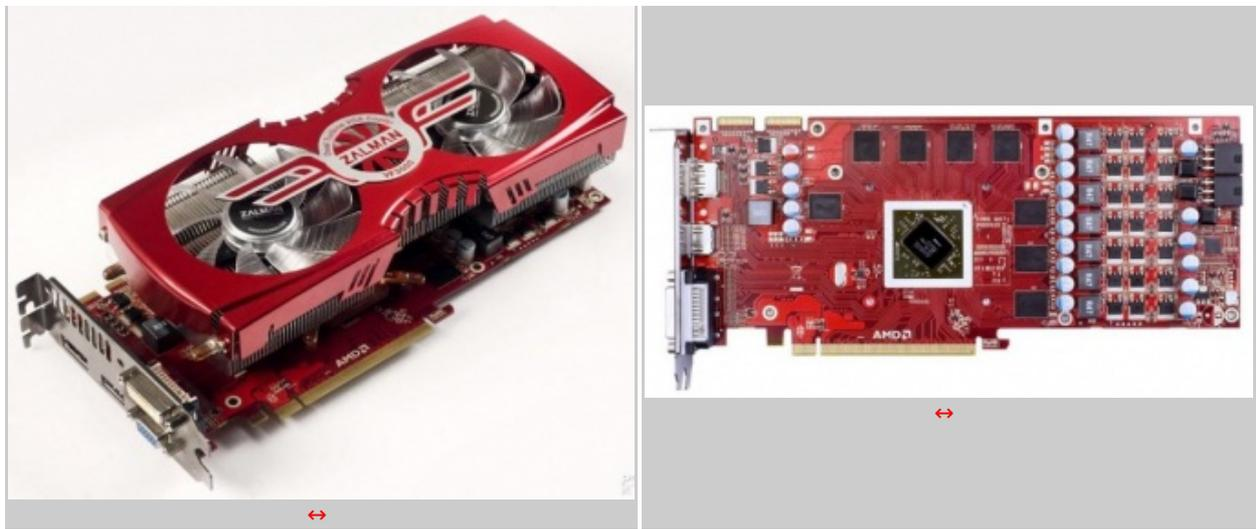
La VGA in questione dispone di un PCB di colore rosso altamente ottimizzato, un dissipatore Zalman VF3000 anch'esso di colore rosso, e due connettori CrossFire che permettono configurazioni con 4 VGA. La scheda ha anche un'alimentazione digitale PWM a 6 fasi, 1GB di memoria GDDR5, 960 Stream Processors, due connettori di alimentazione PCIe a 6 pin, uscite video D-Sub, DVI, HDMI e DisplayPort.
