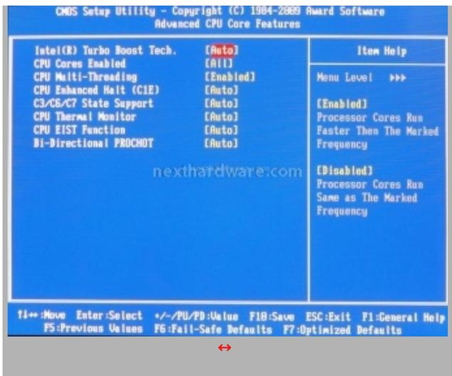
Da Advanced CPU Core Features è possibile abilitare o disabilitare le funzioni di risparmio energetico e Turbo Boost. Le CPU Intel Core i7 e i5 supportano gli stati di sleep dal C1E fino al C7, garantendo una notevole riduzione dei consumi quando la CPU non è utilizzata.
