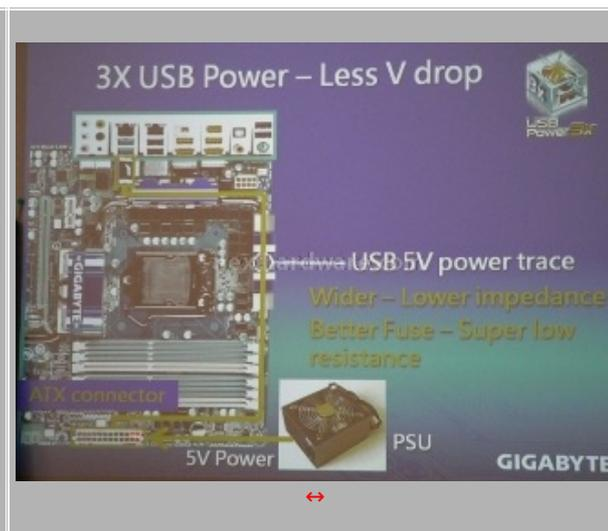
A differenza dei produttori concorrenti, Gigabyte ha deciso di proteggere ogni singola porta USB con un fusibile per evitare il danneggiamento dei dispositivi in caso di incuria o guasto di una delle periferiche in uso; in genere un singolo fusibile è condiviso tra 2-4 porte. Questa modifica riduce inoltre i costi di manutenzione in caso di guasto di una delle porte, richiedendo la sostituzione del solo componente realmente guasto.
