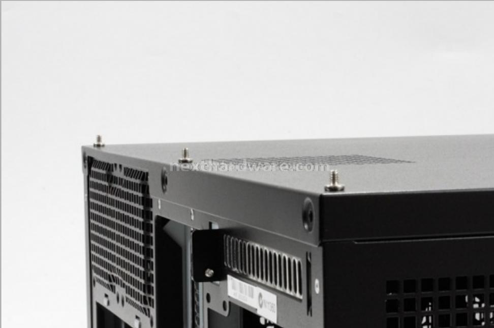
Per rimuovere il top, è necessario svitare le tre viti di serraggio dello stesso. A questo punto basterà tirare il pannello in direzione della parte posteriore e sollevarlo.
