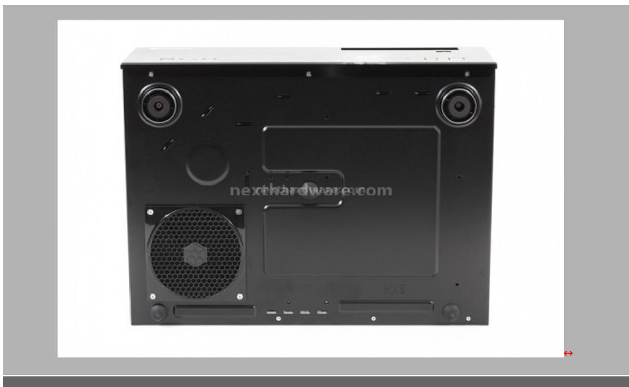
La parte inferiore non pecca per rifiniture, risulta in effetti ottimamente realizzata. Ben 5 i piedini per la massima stabilità dell'appoggio, i due frontali ricalcano in pieno il design di quelli dei sistemi HI-FI professionali. Bello da vedere il filtro per la ventola dell'alimentatore.
