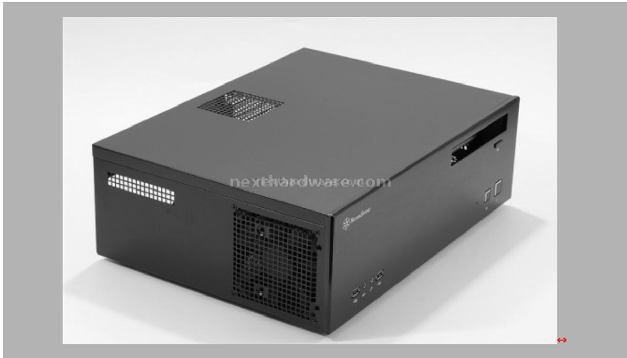
Il top ricalca le linee generali del prodotto, un pannello in lamiera con un'ottima e resistente verniciatura nera. Una piccola griglia disposta verso la parte posteriore favorisce l'uscita dell'aria calda, non è presente alcuna predisposizione per il montaggio di una ventola. Il pannello superiore è assicurato alla struttura portante per mezzo di tre viti disposte posteriormente.
