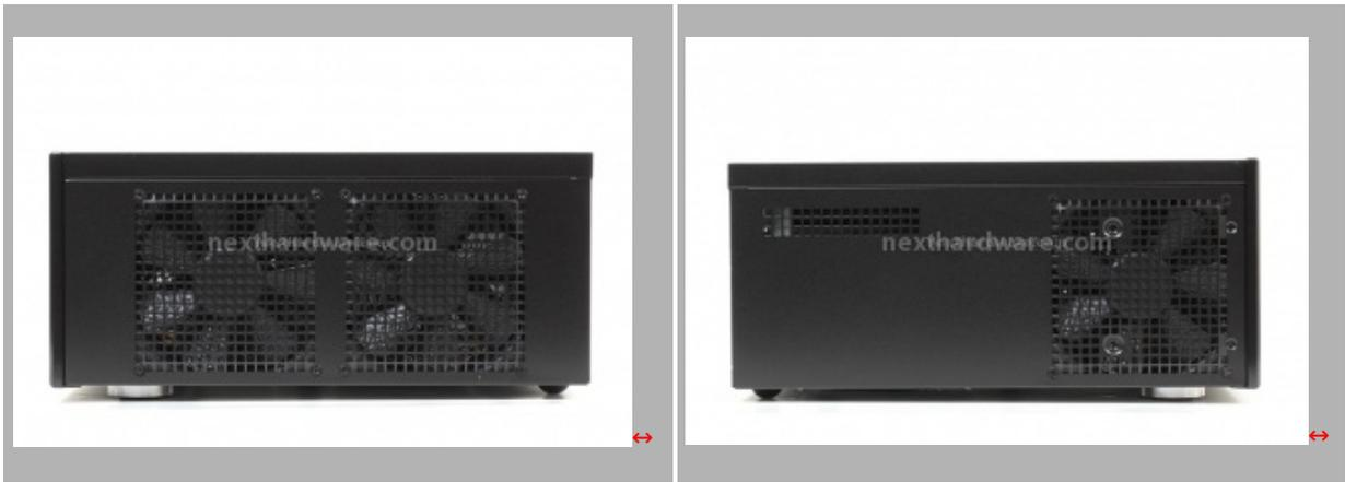
Le due pareti laterali recano le sedi delle ventole dedicate al raffreddamento interno, tutte disposte in immissione. Le ventole in totale sono 3 ed hanno dimensioni di 120x120x25mm. La predisposizione posta sulla parete di destra consente anche l'adozione di una ventola da 80mm di lato, in luogo di quella in dotazione.
