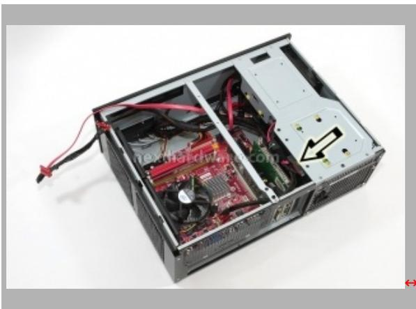
Operazioni quasi ultimate. Notare come i cavi non intralciano e rimangono ordinati. La freccia indica il "gommino" per il passaggio dei cavi dell'hd, montato nella staffa. Osservando attraverso i fori vicini ai disaccoppiatori, è possibile notare il colore verde del PCB relativo alla periferica di memorizzazione che risulta quindi montata a "capancia in su".
