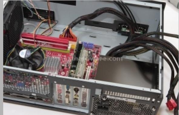
Adottiamo quindi una configurazione differente, dotando il nostro pc di una VGA single slot con raffreddamento passivo. In questo caso è possibile tornare ad utilizzare anche il secondo slot PCI nel quale inseriamo una scheda TV. Il setup in questo caso non è sicuramente orientato al gaming, ma garantisce sicuramente buonissime prestazioni in ambito Home Theatre.
