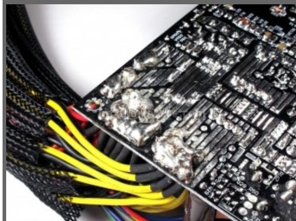
Buono nel complesso il PCB del TX 950. Il layout è abbastanza pulito e le piste sembrano ben dimensionate.
