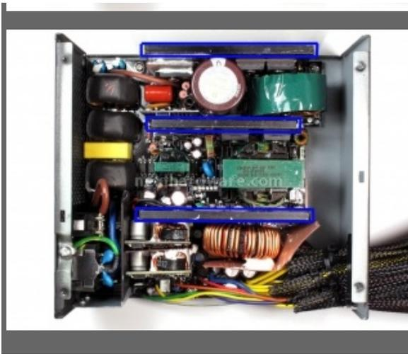
temperature di esercizio accettabili, anche con un'area dissipante ridotta a delle semplici "base" su cui avvitare i componenti.
