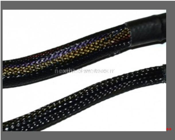
Rivestimento multifilo per tutte le connessioni a disposizione. Sleaving non esageratamente curato per quanto riguarda la precisione con cui vengono rivestiti i cavi.
