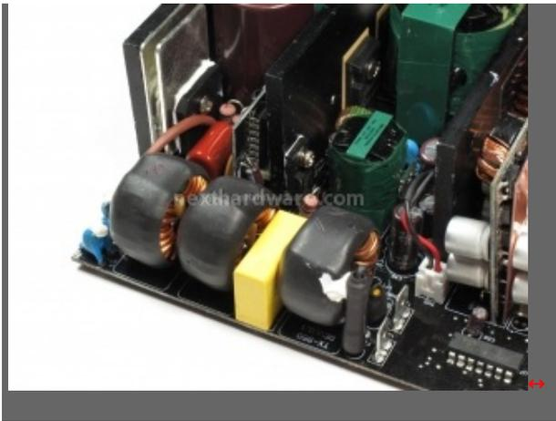
Lato filtraggio corrente: solita sequenza di toroidi e condensatori utilizzati come filtro passivo per eliminare i disturbi dalla corrente AC in ingresso. Possiamo osservare anche i due rettificatori di tensione nell'angolo in alto a sinistra.
