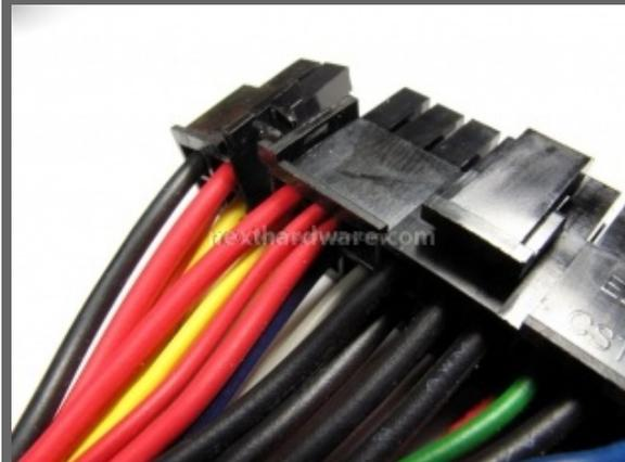
In queste immagini possiamo notare un particolare abbastanza insolito negli alimentatori moderni, sono presenti infatti sensewires per le tre linee principali. Il sensewire è un ponte tra il connettore ATX e l'alimentatore che serve a monitorare la tensione in uscita direttamente dove viene assorbita, permettendo di controllare con maggiore precisione la regolazione di quest'ultima.
