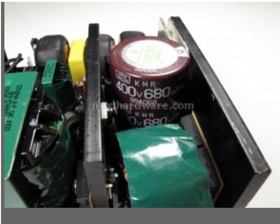
Singolo condensatore in input.
