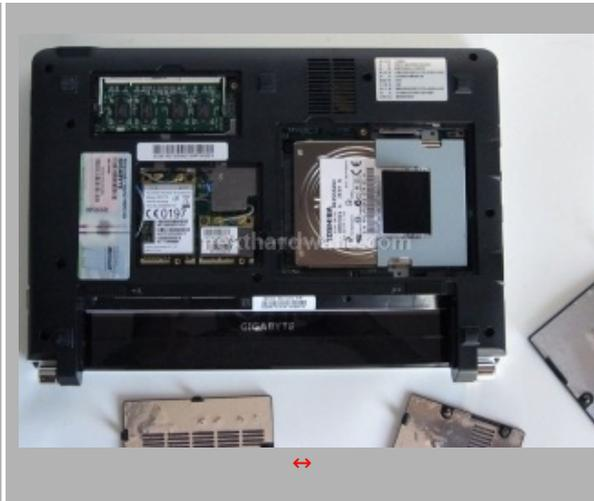
Tutti i componenti interni sostituibili dall'utente sono protetti da sportelli in plastica rivestiti di alluminio per migliorare la dissipazione del calore. Ogni vano è facilmente identificabile e ispezionabile in modo indipendente.
