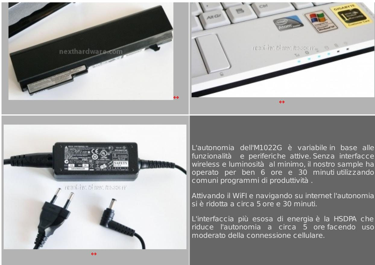
L'autonomia dell'M1022G è variabile in base alle funzionalità e periferiche attive. Senza interfacce wireless e luminosità al minimo, il nostro sample ha operato per ben 6 ore e 30 minuti utilizzando comuni programmi di produttività .
