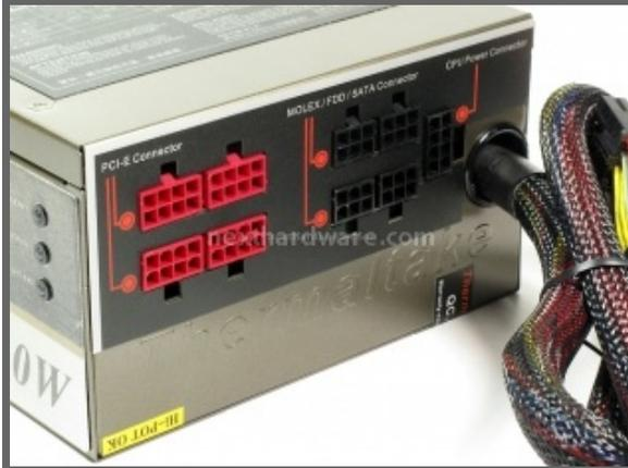
Pannello delle connessioni modulari: semplice, chiaro e facilmente accessibile, unica parte leggermente più scomoda il connettore di alimentazione ATX 4/8 pin che si innesta molto vicino al cavo ATX 24pin.
