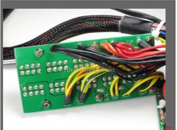
Pannello connessioni modulari estremamente semplice: abbiamo parlato proprio nell'ultima recensione degli svantaggi in termini di efficienza che porta questa soluzione per le connessioni modulari. Non a caso questo amplificatore ha una certificazione 80 Plus relativamente bassa rispetto ad alcuni concorrenti.
