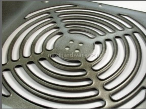
In questa sequenza di immagini viene evidenziato il sistema di lavorazione che trasforma il cabinet in una griglia di elevata resistenza. I margini di ogni foro accuratamente ripiegati verso l'interno favoriscono il flusso d'aria eliminando le turbolenze.
