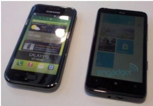
Il prossimo palmare di casa HTC sarà l'HD7, un terminale dotato del nuovo OS Windows Phone 7 e di una configurazione hardware top gamma. Il dispositivo misura 112 x 68 x 11,2 millimetri e dispone di uno schermo touchscreen capacitivo da 4.3 pollici, un processore Snapdragon da 1GHZ modello QSD 8250, una memoria RAM di 576MB, una ROM di 512MB, uno storage interno di 8GB, una fotocamera da 5 megapixel, accelerometro, WiFi 802.11 b/g/n, bluetooth 2.1 e audio Dolby Mobile.
