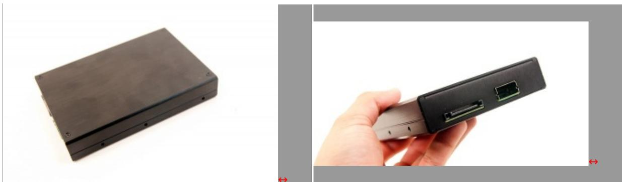
Gli SSD IBIS, realizzati con quattro controller SandForce SF-1200 in configurazione Raid 0, saranno disponibili in tagli da 100, 160, 240, 360, 480, 720 e 960 GB. Capaci di oltre 700 MB/s di transfer rate sia in lettura che in scrittura e accreditati di 120.000 IOPS su scritture random allineate di blocchi da 4KB saranno prossimamente commercializzati, adattatore HSDL a singola porta incluso, a partire da 579,- (prezzo indicativo suscettibile di variazioni).
