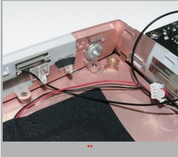
La scheda WIFI è conforme allo standard 802.11 n/g/b, le antenne sono poste perpendicolarmente l'una all'altra sui due lati superiori del MAG.
