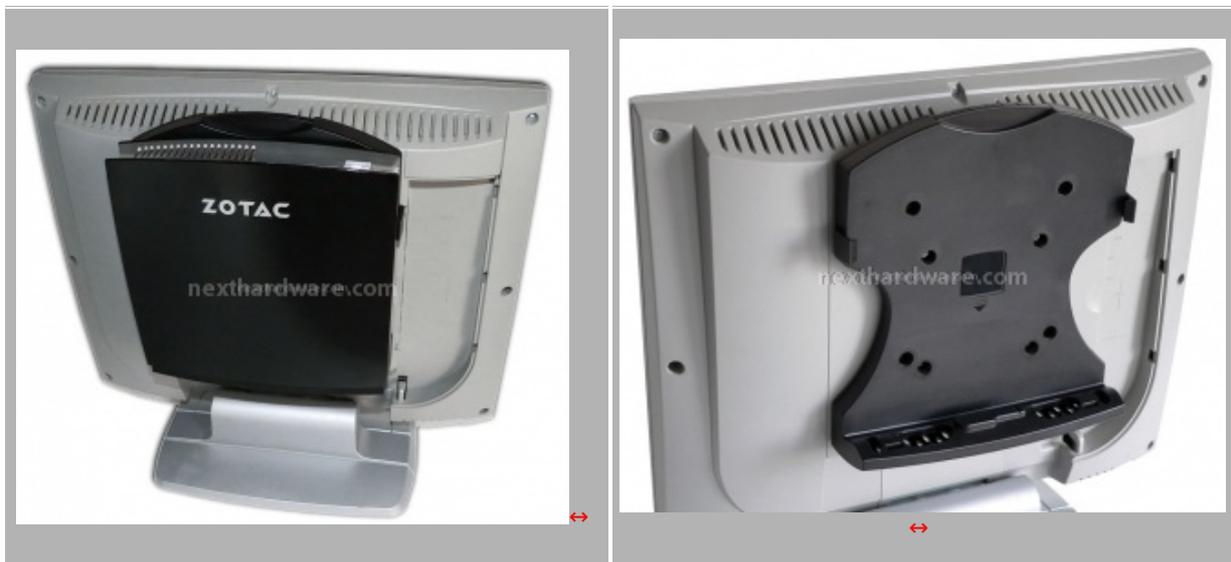
Lo standard di montaggio VESA è nato per l'installazione dei monitor LCD e Plasma a muro o con bracci orientabili. Zotac ha incluso nella confezione del MAG un'apposita staffa per l'installazione del suo mini PC sul retro di ogni LCD o Plasma compatibile, riducendo a zero l'ingombro sulla scrivania. La staffa è adattabile alle varie versioni dello standard grazie a 3 differenti forature, sono inoltre incluse le viti di montaggio.
