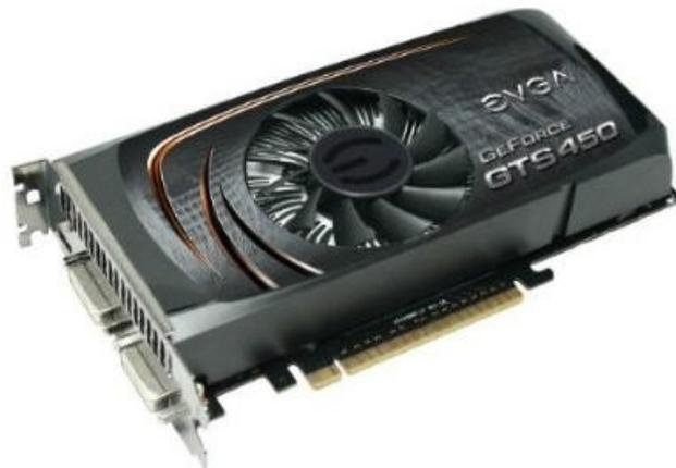
Il prodotto dispone di un dispositivo di raffreddamento dual-slot, 192 core CUDA, 1GB di memoria GDDR5, un'interfaccia di memoria a 128-bit, e frequenze di clock superiori rispetto alla versione standard per GPU (882 MHz), Shader (1764 MHz), e memorie (3800 MHz).
