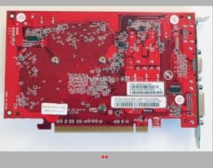
Il design del PCB è estremamente semplice ed è caratterizzato da un numero molto contenuto di componenti. La V-RAM è composta da quattro moduli di memoria GDDR3 di produzione Qimonda, saldati tutti sullo stesso lato del PCB e connessi alla GPU con un bus a 128 bit, una innovazione per questa categoria di prodotti, legata per troppi anni ad un bus a 64bit (attualmente in uso solo per la GT210).
