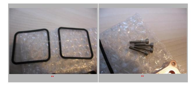
I due oring di tenuta sono identici; in materiale plastico e con la stessa forma degli scavi che andranno ad accorglierli. Le quattro brugole che andranno a serrare il waterblock sono in acciaio.
