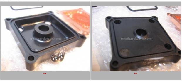
La camera intermedia è costruita in delrin ed è l'elemento maggiormente innovativo. Il suo compito è quello di incanalare il flusso dagli angoli del waterblock nel raccordo di uscita. Questo particolare disegno consente di minimizzare la perdita di pressione consentendo al fuZion di poter lavorare anche con pompe modeste. In entrambi i lati è presente l'incanalatura che andrà ad accogliere i due oring.
