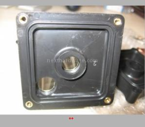
Il top è in delrin, presenta le due filettature per i raccordi e le 4 per le brugole che andranno a serrare il waterblock. Il foro centrale è quello d'ingresso mentre in quello dell'angolo verrà incanalato il flusso di uscita. E' presente uno svaso per ospitare l'oring di tenuta. I raccordi hanno un diamentro interno di circa 11mm ed assicurano un'ottima tenuta su tubi da 12 e 10mm di interno.
