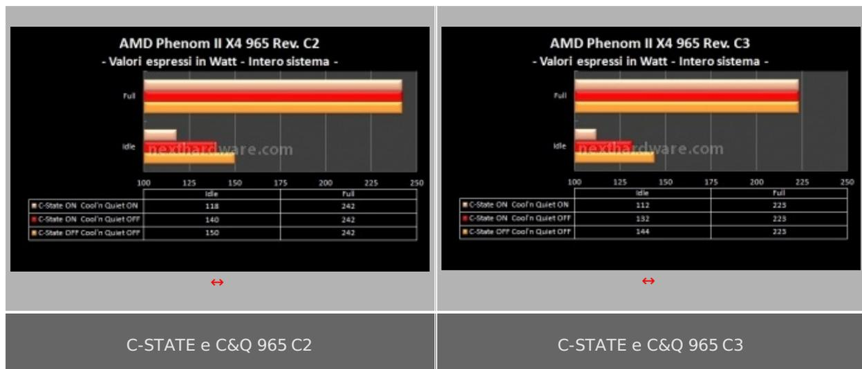
Le funzionalità di risparmio energetico hanno significato solo in IDLE, infatti quando il processore lavora a pieno carico non vengono ridotte le frequenze di funzionamento (pena un decadimento delle prestazioni). Le modalità C-State della versione C3 del Phenom II X4 965 non si mostrano particolarmente più efficienti di quelle presenti nella revisione C2, i consumi sono comunque più ridotti in ogni condizione operativa.
