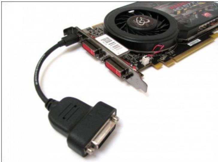
AMD ha messo a punto un convertitore attivo da DisplayPort a DVI, che permette alle masse di creare configurazioni Eyefinity più facilmente. L'adattatore si collega ai connettori Mini DisplayPort presenti sulla scheda grafica ATI Radeon, e dà in uscita un segnale single-link DVI. La conversione a DP a DVI è attiva, e quindi conserva la qualità video, così come la protezione dei contenuti.
