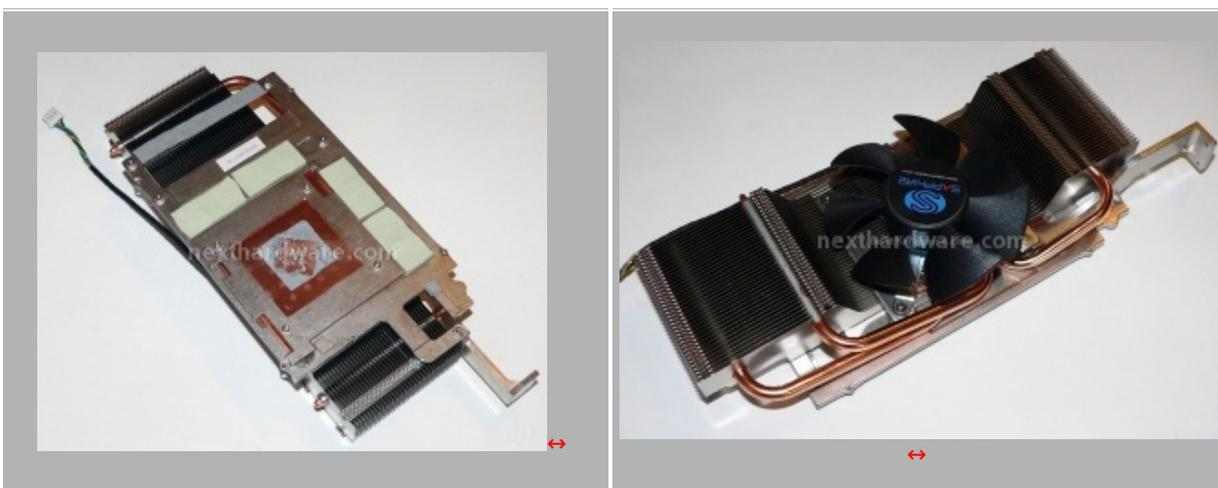
La vapor chamber è costruita in rame e saldata ad un robusto corpo in alluminio che fa da struttura portante per il dissipatore. Tre heatpipe di generose dimensioni, portano il calore della vapor chamber ai due dissipatori in alluminio che circondano la ventola di raffreddamento e che occupano quasi tutta la lunghezza della scheda video. La ventola è silenziosa e regolata automaticamente in base alle temperature di esercizio della scheda video.
