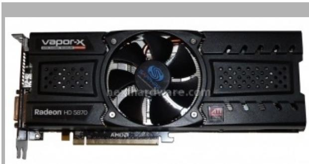
Il design della HD 5870 Vapor-X è decisamente più gradevole della versione reference, la cover è completamente nera e il dissipatore è dotato di una singola ventola 80x80mm.
