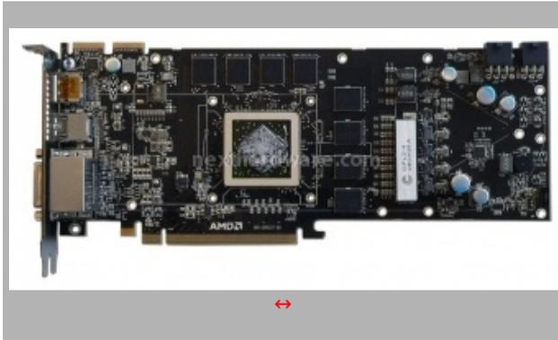
La scheda è dotata di 8 moduli di memoria GDDR5 disposti ad L attorno alla GPU RV 870. Sulla destra è visibile la sezione di alimentazione. La scheda è accreditata di un consumo di 188 w a pieno carico, è quindi necessario collegare 2 cavi PCI-E 6 pin per garantire il corretto funzionamento del prodotto.
