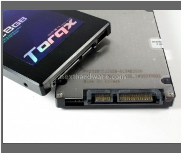
Lato connessioni: oltre alla consueta presa Sata di alimentazione e di trasferimento dati è presente l'alloggiamento per un Jumper. Osservando il circuito ad esso collegato, possiamo notare che i due pin siano collegati al Jumper n° 5. Nelle prime versioni di SSD basati su controller Indilinx, questo jumper andava chiuso per poter abilitare la modalità engineering necessaria per l'aggiornamento del Firmware.
