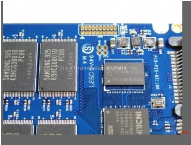
Il controller è associato ad una cache Elpida SDRAM DDR da 166mhz CL3 della capacità di 64mb.
