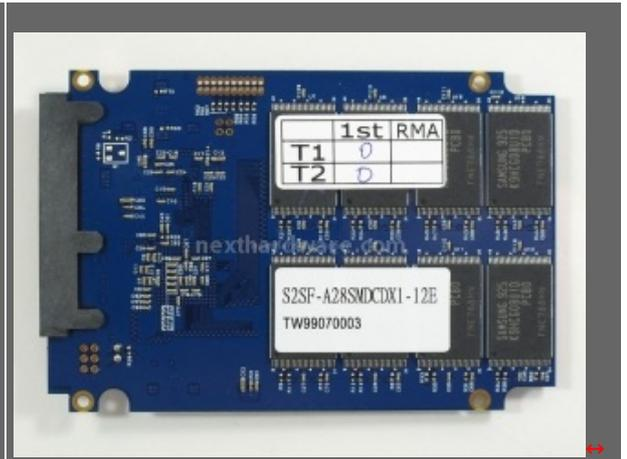
Pcb di colore blu e disposizione ordinaria per questo Indilinx. 16 Nand Flash MLC da 8Gbyte disposte perpendicolarmente rispetto al controller. Configurazione questa adottata dalla quasi totalità degli SSD dotati di questo controller.
