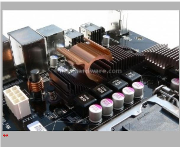
Tutti i condensatori installati sulla P55H-A sono di tipo solido, una caratteristica difficile da ritrovare nelle schede madri meno costose. Il circuito di alimentazione della CPU è composto da 6 fasi più una dedicata al VTT. I dissipatori dei mosfet sono particolarmente curati esteticamente, la parte ramata rappresenta un drago stilizzato. Il socket è di produzione Foxconn.
