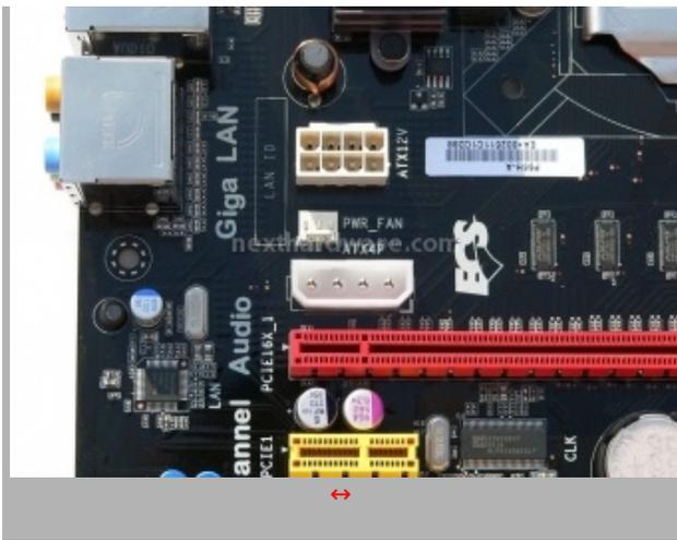
Il connettore 8 PIN di alimentazione è posto in una posizione non consueta, ma facilmente raggiungibile in tutti i case.
