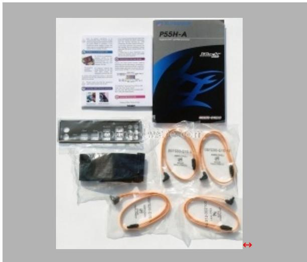
Il bundle è limitato ma include 4 cavi SATA2, 1 cavo EIDE ATA 133, una maschera per il Back I/O e due manuali d'uso.
