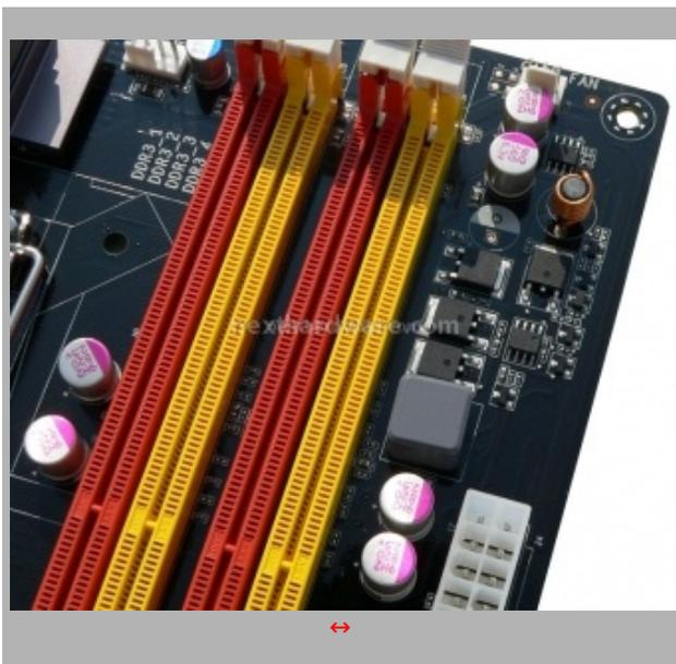
La scheda è dotata di 4 slot per memorie DDR3 low voltage (max 1.65 v secondo specifiche Intel). I moduli sono alimentati con una singola fase di alimentazione dedicata.
