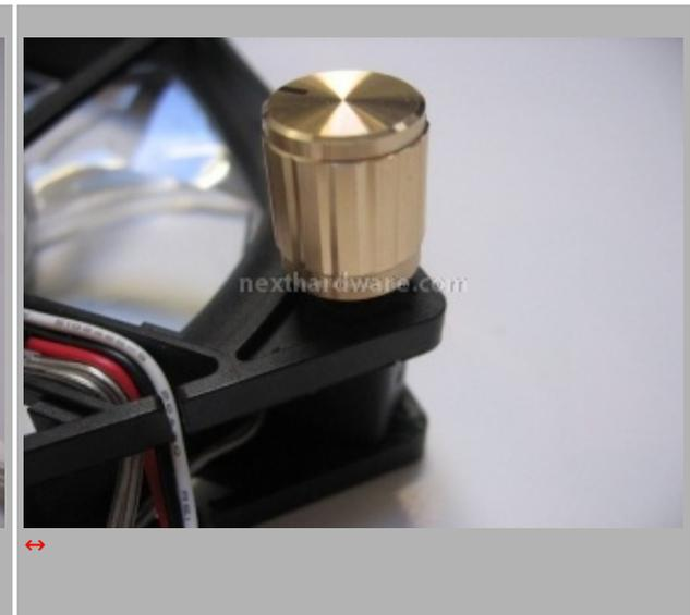
Il potenziometro è basato su una struttura in materiale plastico studiata per andarsi a fissare in uno degli angoli della ventola. E' possibile montare il potenziometro in entrambi i lati , cosi da permettere la massima flessibilità per l'utilizzo del regolatore.
