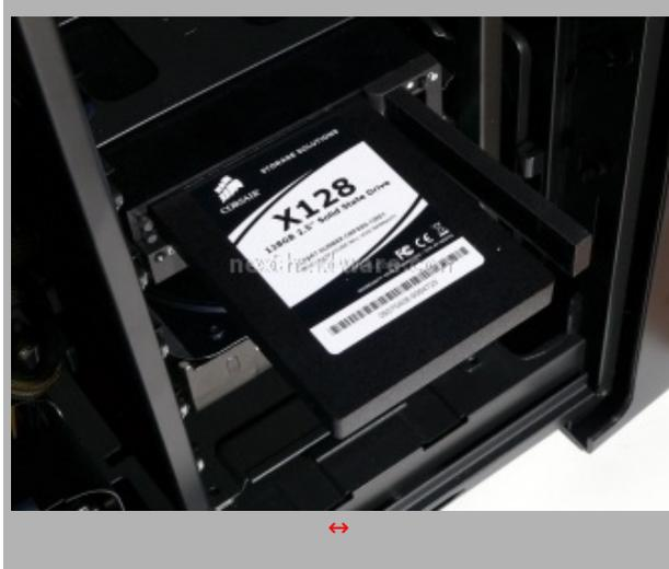
Il Corsair X128 è stato installato in un bay prodotto da SNT, modello ST-2221SATA. Questo box permette di montare due dischi da 2.5" senza l'uso di scomodi adattatori, ne di alcun attrezzo, il montaggio è infatti completamente toolfree. Un blocco di sicurezza impedisce la rimozione accidentale del disco. Come si può vedere in foto, il secondo cavo SATA non era collegato nel nostro sistema di prova, per chi volesse utilizzare il secondo bay è bene accertarsi che tutti i cavi siano al loro posto.
