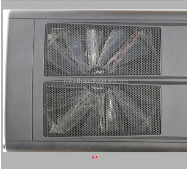
Nella parte posteriore del tetto del case è presente una imponente ventola da 230 x 230 x 20 mm dotata di LED rossi. Il regime di rotazione è di 800 rpm con una rumorosità dichiarata di 15 dBA con 76.0 CFM di portata d'aria. Il raffreddamento del sistema è quindi ottimale e non sono presenti ristagni di calore all'interno del case.
