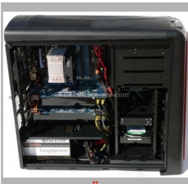
La parte centrale del case è occupata dalla scheda madre e dalle VGA di produzione Gigabyte (P55-UD6 e GeForce GTX 275 rispettivamente).
