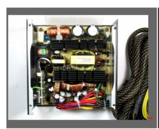
In questa visuale dall'alto potete osservare le esigue dimensioni dei dissipatori utilizzati, sarà interessante scoprire se, una volta caricato l'alimentatore, saranno in grado di dissipare il calore generato.
