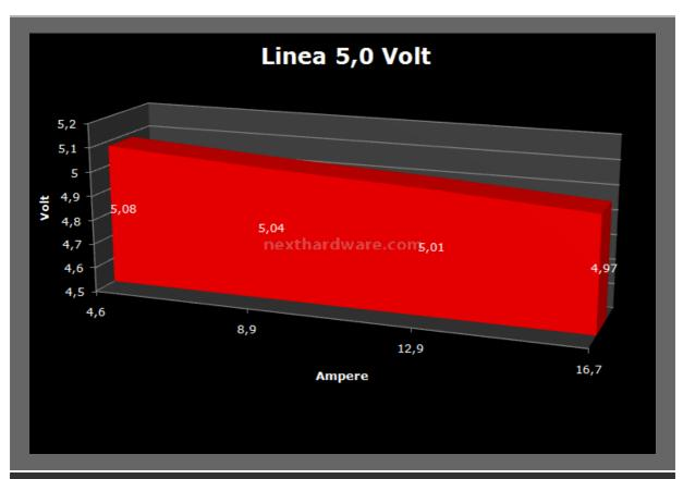
Sebbene nei test in crossloading l'Enermax si sia fatto notare per un buon comportamento anche nei test che interessano il rail +5,0volt, da questo grafico possiamo ulteriormente apprezzare il minimo calo di voltaggio e la buona linearità .
