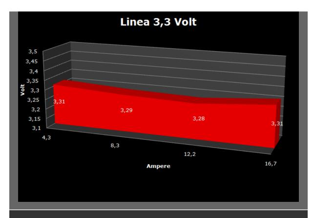
In questo test, dove il carico sulle varie linea ha una progressione lineare, registriamo valori più costanti rispetto al test precedente. Anche in questa occasione potete notare come l'alimentatore tenda a compensare autonomamente il Vdrop, restituendo un voltaggio nella ultima misurazione identico a quello iniziale.
