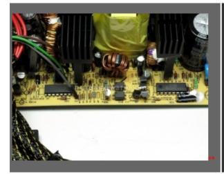
Ecco i due chip di controllo protagonisti del sistema **SafeGuard** che tiene sotto controllo gli otto sistemi di protezione presenti in questo alimentatore.
