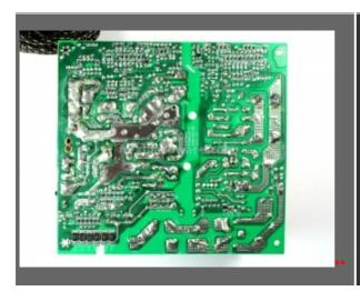
Enermax ci aveva abituato, anche per quanto riguarda gli alimentatori top gamma, a dei PCB di alta qualità ma sempre caratterizzati da qualche filamento metallico di "supporto†annegato nello stagno. Probabilmente le nostre lamentele sono state ascoltate, come potete vedere dall'immagine, la porzione di circuito che collega il negativo viene "rinforzata†con una barretta che segue la forma della pista.
