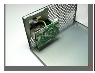
Particolare del piccolo circuito collegato alla presa di alimentazione, utilizzato come primo filtro Anti-FMI.
