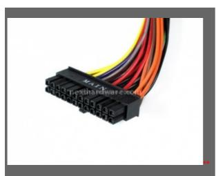
Cavo di alimentazione ATX 24pin
