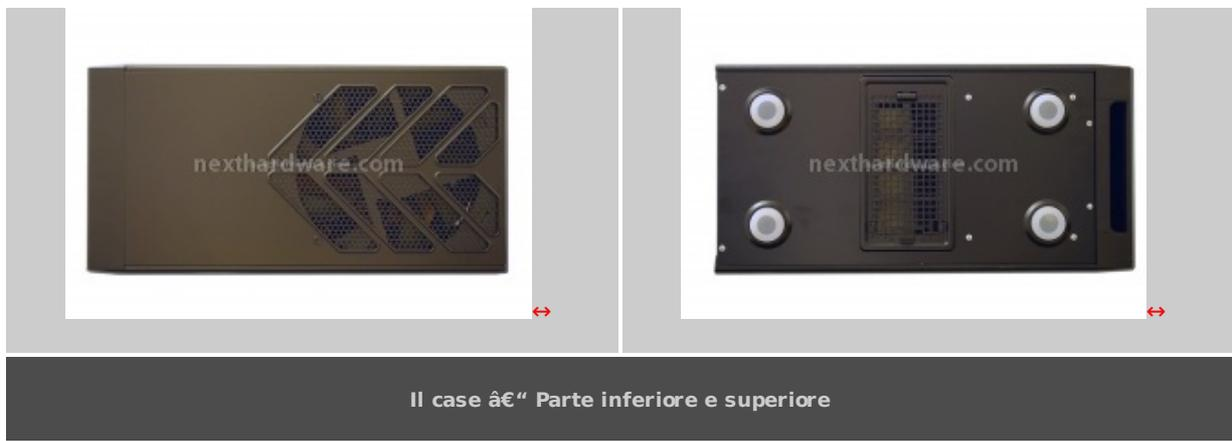
Nella parte alta del case subito si nota l'imponente ventola di estrazione da 20 cm, la quale può essere regolata in termini di velocità a seconda delle nostre esigenze. Il pavimento del case mostra invece una presa d'aria necessaria all'alimentatore e dotata di un filtro anti polvere rimovibile. Si nota inoltre la presenza di quattro piedini in gomma morbida che consentono di ridurre la trasmissione di vibrazioni al pavimento.
