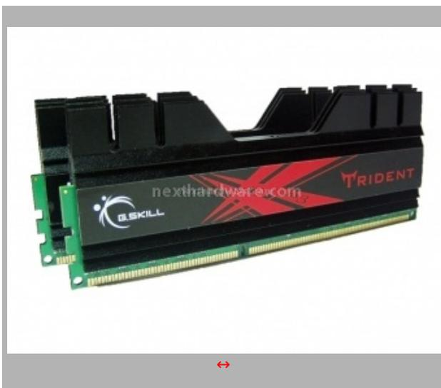
Ogni modulo di memoria utilizza un sistema di raffreddamento proprietario in alluminio anodizzato nero. Il dissipatore permette di smaltire adeguatamente il calore prodotto durante il funzionamento in overlock.
