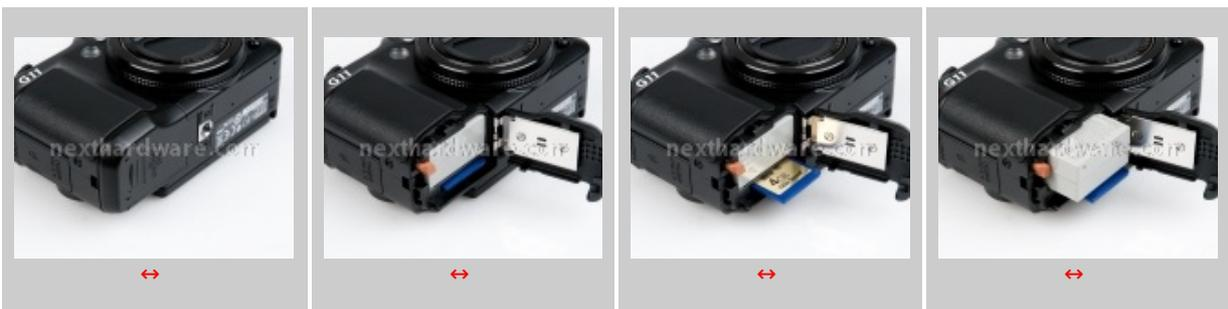
Il comparto inferiore ospita la batteria Li-Ion da 1050 mAh e la memoria in standard SD/SDHC.
