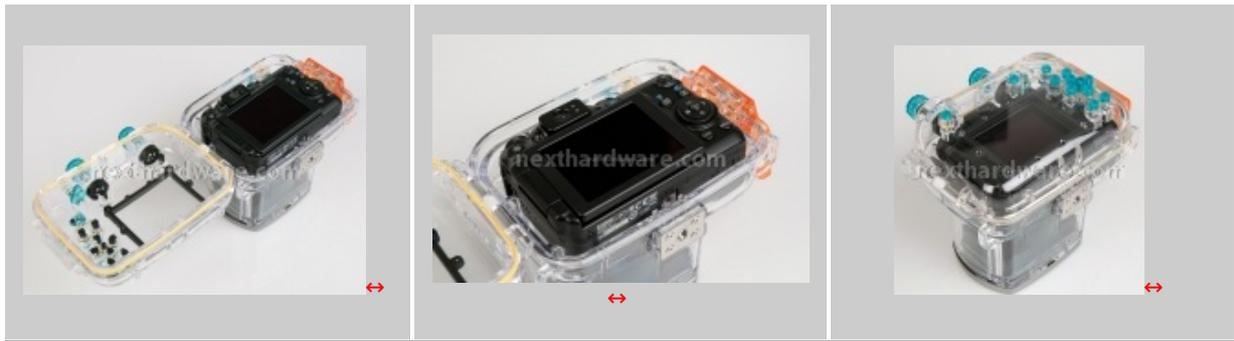
Fasi di innesto del corpo macchina G11 all'interno dello scafandro: prima di chiudere accertatevi di aver ruotato l'LCD della fotocamera!
