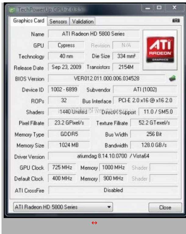
La nuova versione 0.3.5 di GPU-Z riconosce correttamente la HD5850, mostrandone le caratteristiche e le frequenze di funzionamento.
