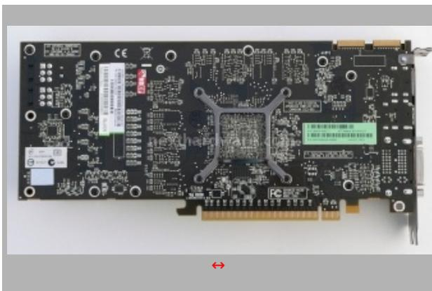
La scheda è compatibile con lo standard PCI-E 16x 2.0, è possibile utilizzarla anche con schede dotate di slot di generazione precedente senza impattare in modo sensibile le prestazioni, è necessario valutare però un acquisto pesato alle potenzialità degli altri componenti del sistema, in modo da non castrare la vga.
