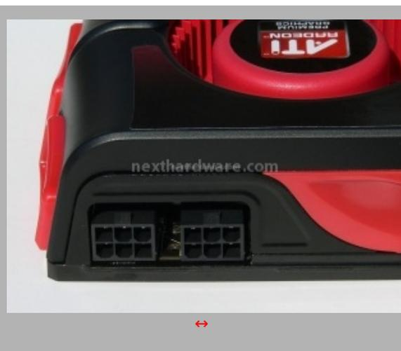
Sono necessari due connettori PCI-E 6 pin da 75w per alimentare la HD5870, il resto dell'energia sarà prelevato dallo slot PCI-E 16x. Le future versioni dual GPU saranno probabilmente equipaggiate con un connettore da 6 pin e uno da 8 dato l'elevato assorbimento energetico.
