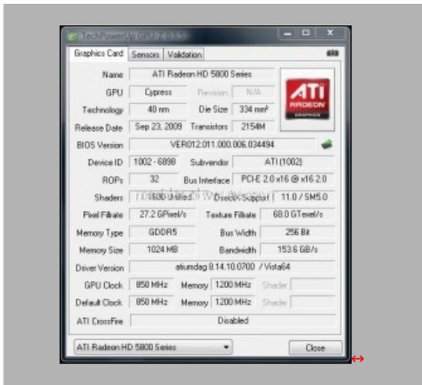
La nuova versione 0.3.5 di GPU-Z riconosce correttamente la HD5870, mostrandone le caratteristiche e le frequenze di funzionamento.
