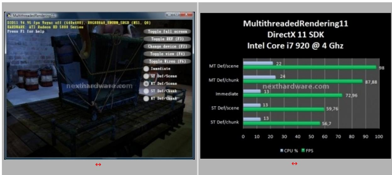
Le modalità ST sono a solo scopo dimostrativo e prevedono l'utilizzo di un solo thread per gestire il rendering dei singoli frame, nella modalità scene questa operazione avviene in modo sequenziale, in modalità chunk i frame vengono renderizzati in contesti differenti.
