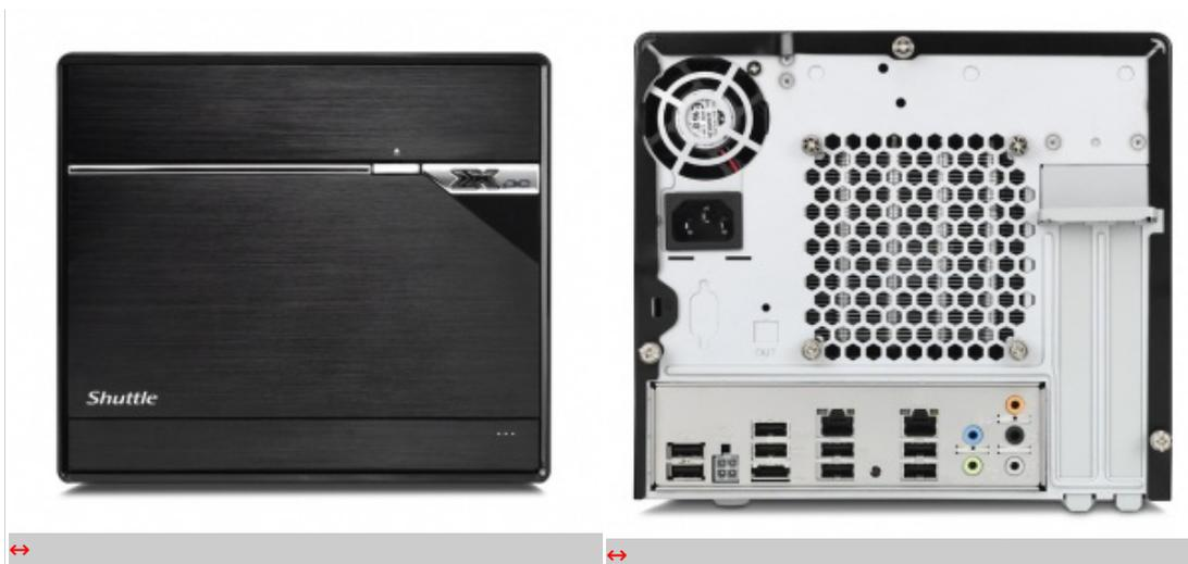
Il pannello frontale integra un card reader per le schede più comuni presenti in commercio. Il sistema di raffreddamento a heatpipe garantisce un'ottima stabilità e l'alimentazione è garantita da un PSU certificato 80 PLUS con una potenza di 500 Watt.
