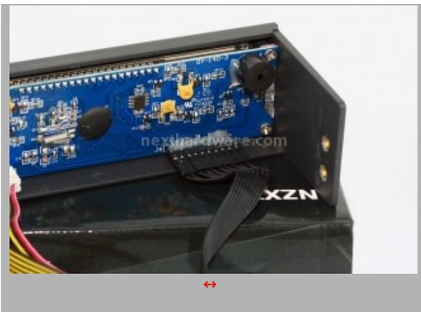
Particolare dei connettori relativi ai collegamenti alle ventole ed alle sonde di temperatura, i plug sono letteralmente "incollati". La soluzione, a nostro avviso è discutibile, in quanto vorremmo avere la possibilità di scegliere quanti e quali cavi utilizzare, per questione di spazio ed ordine.
