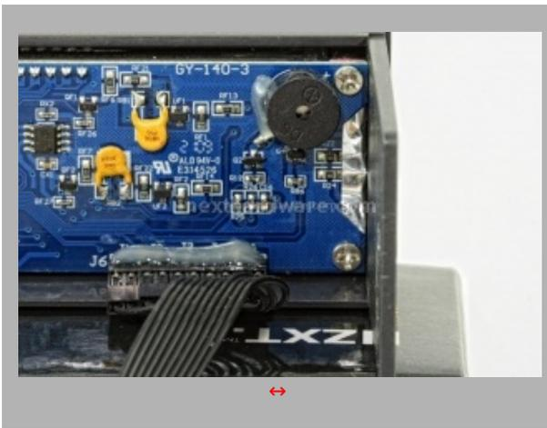
Il buzzer del sistema di allarme, notare la pregevole pulizia del pcb e la ricchezza di componentistica smd.
