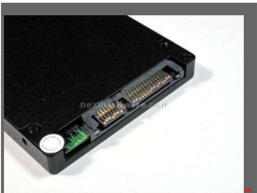
Lato connessioni: Oltre alla consueta presa Sata di alimentazione e di trasferimento dati,   presente l'alloggiamento per un Jumper. Osservando il circuito ad esso collegato, possiamo notare che i due pin siano connessi al Jumper n  5. Nelle prime versioni di SSD basati su controller Indilinx, questo jumper andava chiuso per poter abilitare la modalit  engineering, condizione necessaria per l'aggiornamento del Firmware.
