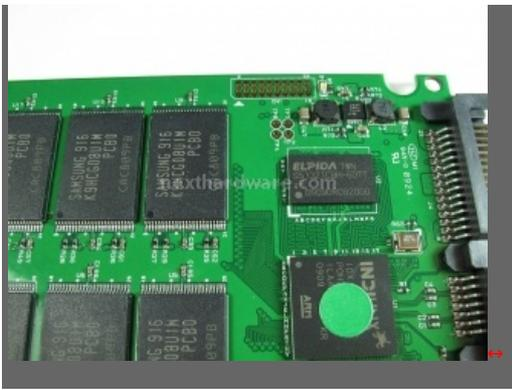
La logica è associata ad una cache Elpidia SDRAM DDR da 166mhz CL3 della capacità di 64mb.
