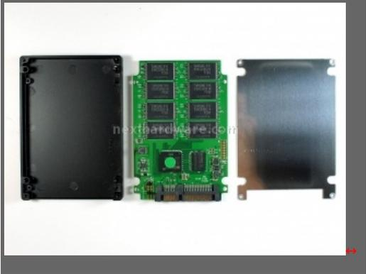
Rotti i sigilli di garanzia, che nascondevano 2 delle 4 viti necessarie ad assicurare il fondo del SSD alla struttura, abbiamo accesso al circuito. Quest'ultimo è assicurato al top tramite altre 4 viti.
