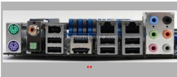
Il Back I/O è completo ed integra 2 porte PS2, 7 porte USB 2.0, 2 interfacce di rete RJ45, 1 porta Combo E-SATA/USB, 1 porta firewire, un connettore coassiale e uno ottico per l'audio multicanale e 6 jack analogici con funzionalità di auto riconoscimento.
