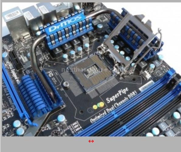
L'apertura del Socket 1156 è semplice, è infatti sufficiente sbloccare e sollevare la clip metallica sulla destra della gabbietta di ritenzione del processore.
