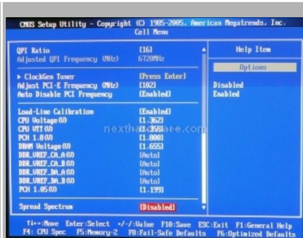
Nella seconda parte del Cell Menù è presente una completa regolazione dei voltaggi. Purtroppo le impostazioni per il VTT sono limitate, si spera in un futuro aggiornamento per rendere più precisa questa regolazione. Da notare i voltaggi separati per una migliore gestione delle memorie.
