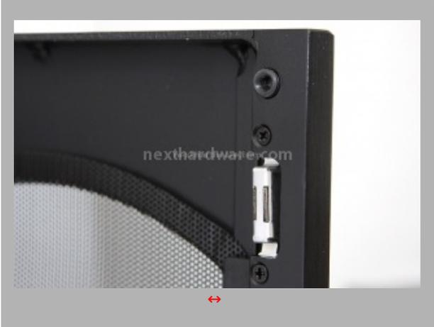
Aprendo lo sportello frontale, con sistema di chiusura a magneti, accediamo ai vani periferiche e possiamo vedere in basso la sede della ventola frontale protetta da una mesh metallica forata. Cinque gli slot da 5,25" a disposizione, sufficienti per qualsiasi configurazione della nostra macchina. Apprezzabile la presenza dell'ormai dimenticato vano da 3,5", utilissimo per alloggiare un lettore di schede od un fanbus di dimensioni ridotte.
