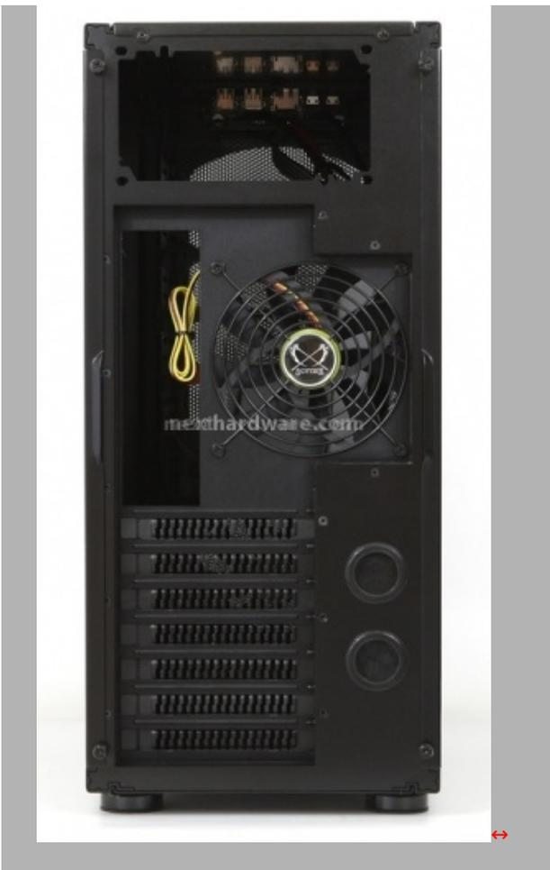
Classica la parte posteriore con disposizione alta dell'alimentatore. In basso a destra sono presenti due predisposizioni per il passaggio di cavi e/o tubature di impianti di raffreddamento a liquido.
