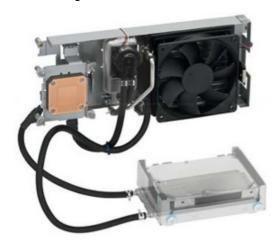
NEC ha rilasciato alcuni dettagli preliminari su un nuovo metodo per il raffreddamento dei processori, sostenendo fortemente che avrà un rendimento migliore rispetto ai sistemi esistenti. In accordo con CrunchGear, l'azienda ha sviluppato un nuovo sistema di raffreddamento basato sul "cambiamento di fase" di una miscela di clorofluorocarburi che bolle a 50 gradi e una volta trasformata in vapore viene spostata in un gruppo scambiatore di calore per essere trasformato nuovamente in liquido.
