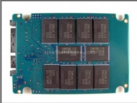
Ecco le due "facce" del P128, come potete vedere ogni componente attivo del circuito è costruito da Samsung. Singolare la disposizione dei chip Nand Flash che non segue uno schema perfettamente simmetrico per entrambi i lati del PCB.
