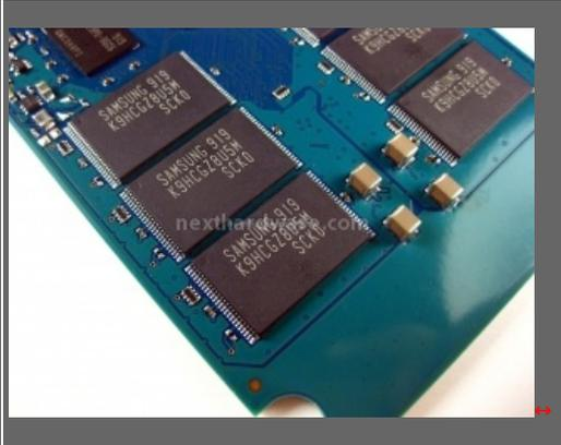
I chip NAND utilizzati sono prodotti, come per il resto dei componenti, da Samsung, chip Multi Layer Cell di recente produzione. Costruiti su 4 strati e di capacità doppia rispetto ai più diffusi K9HCG08U1M.
