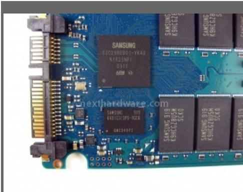
In questa foto potete vedere il protagonista di questo supporto, il nuovo controller Samsung. Questo componente è mosso da una logica ARM in grado di raggiungere prestazioni di 220mb/s in lettura e 200mb/s in scrittura. Il controller è dotato di 8 canali con ampiezza di 8bit.
