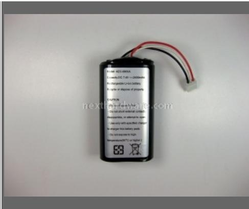
In primo piano la batteria tampone agli ioni di Litio da 2400mAh fornita in dotazione.
