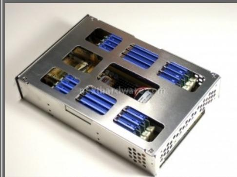
Ecco Acard montato ed equipaggiato di 16Gb di DDR2. Molto bella la struttura esterna in alluminio anodizzato.
