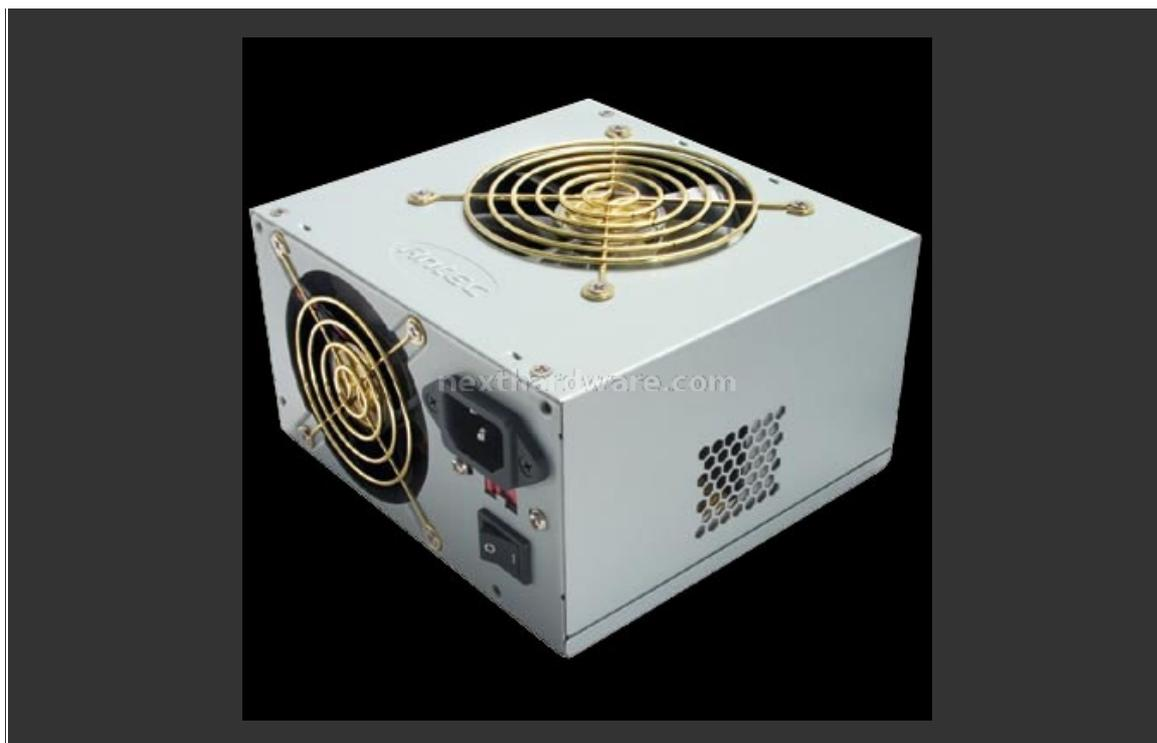
L'alimentatore utilizzava due ventole rispettivamente da 92mm in immissione e da 80mm in espulsione. A differenza di quanto ci si potrebbe aspettare questo alimentatore era estremamente silenzioso.
