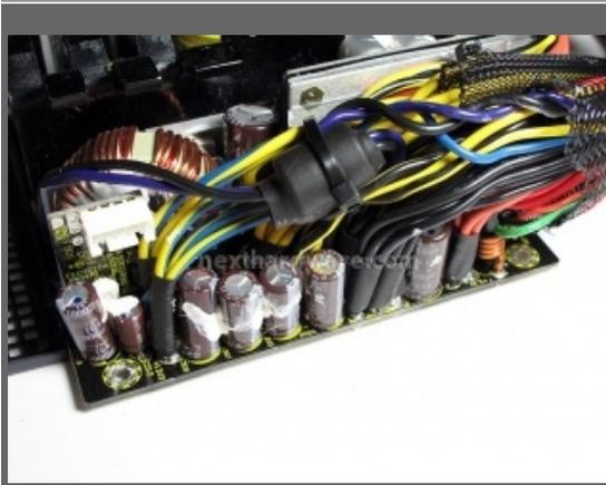
Lato connessioni in uscita: non estremamente ordinato, ma potete vedere come in ogni possibile spazio rimanente i tecnici di Antec hanno disposto condensatori.
