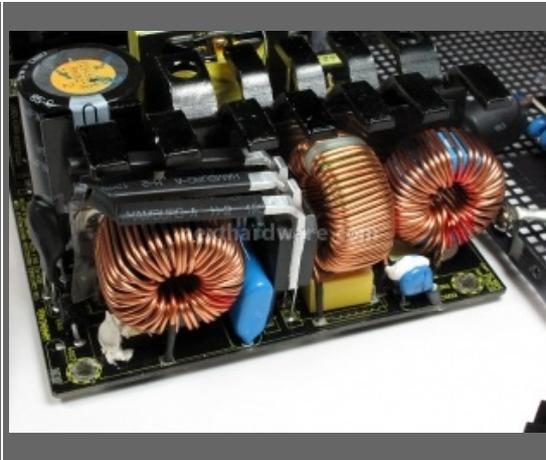
Lato corrente in ingresso, si notano chiaramente i tre toroidi utilizzati come filtri Anti-EMI e il doppio rettificatore di corrente.
