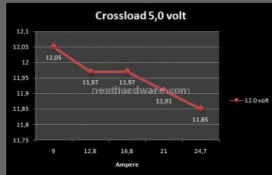
Vdrop relativamente basso per il rail sotto stress. Peccato però che entrambe le altre linee soffrano di un calo di 0,2volt, valore decisamente poco promettente per i prossimi test lineari.
