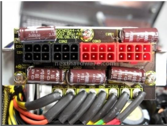
Pannello connessioni modulari: incredibile come in un circuito di dimensioni così ridotte oltre alle connessioni siano presenti anche 5 condensatori. Anche per il lato saldature, come per la Main-Board, il circuito risulta ben fatto.
