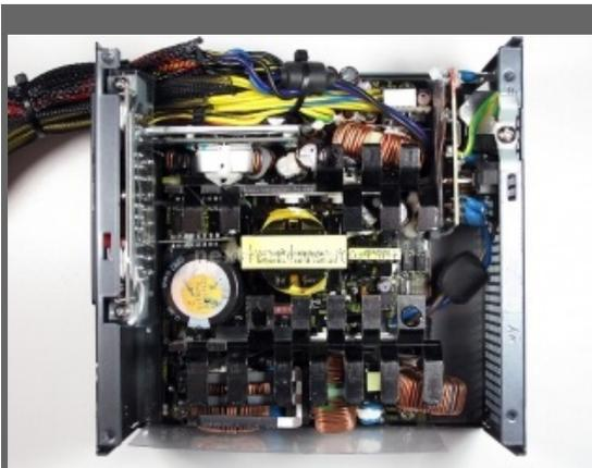
Tutta la sezione dissipatori di questo alimentatore sembra decisamente sottodimensionata, soprattutto se osserviamo la ridotta alettatura dei dissipatori. Vedremo nei prossimi test se l'intero sistema riesce a gestire i 750w di questo alimentatore.
