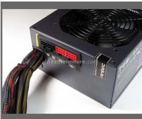
Estremamente semplice ed ordinata la sezione adibita alle connessioni dei cablaggi modulari. Come potete vedere non sono moltissime le connessioni aggiuntive, l'alimentatore infatti è utilizzabile nella maggior parte dei casi senza l'ausilio di alcun cavo modulare. La dotazione di cavi saldati infatti è già più che sufficiente per alimentare tutte le periferiche di una macchina media.
