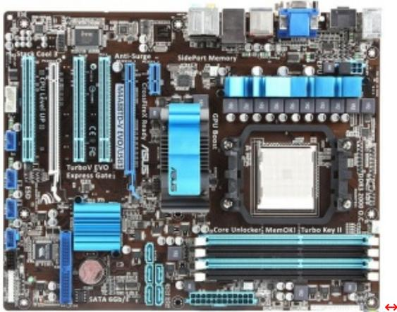
Asus ha presentato la M4A88TD-V EVO/USB 3.0 una mainboard AM3 ready equipaggiata con il nuovo chipset AMD 880G. La M4A88TD-V EVO è dotata di funzione nel bios per lo sblocco dei core dei Phenom II, funzionalità di overclocking TurboV, comprende un instant O.S. Express Gate e vanta quattro slot di memoria DDR3, IGP Radeon HD 4250 con memoria installabile su SidePort e due PCI-Express x16.
