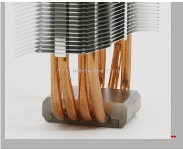
In rame nickelato, con una costruzione a sandwich dove si inseriscono le 4 Heat pipes responsabili della trasmissione del calore. Rispetto al "fratello maggiore" Thermalright Ultra-120 eXtreme perde due dei tubi di calore. Questi ultimi sono saldati alla struttura della base, la soluzione permette il miglior scambio termico possibile. Il tipo di assemblaggio è tipico dei dissipatori di fascia alta, in quanto più costoso del tradizionale "incastro".
