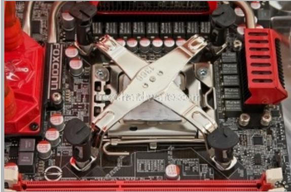
Procediamo con la stesura del "thermal compound" in dotazione. Vi mostriamo quindi la struttura della staffa; è molto semplice intuire quale sia la procedura per un fissaggio corretto del dissipatore al socket.
