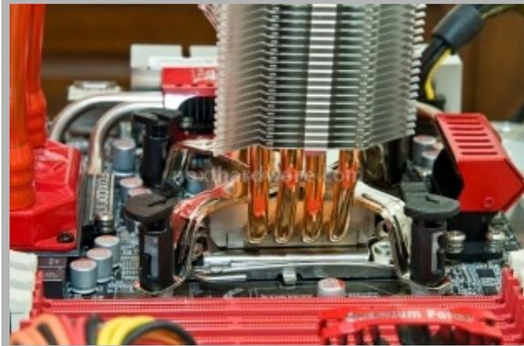
Una volta fissato, facendo attenzione a centrare bene il complesso base/staffa, il dissipatore si presenta saldamente ancorato. Come potete vedere dalle immagini, è opportuno procedere all'installazione con la ventola smontata, per permettere la pressione dei "pushpin" frontali.
