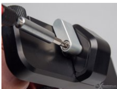
Svitare completamente la leva e aprire il coperchio nero
