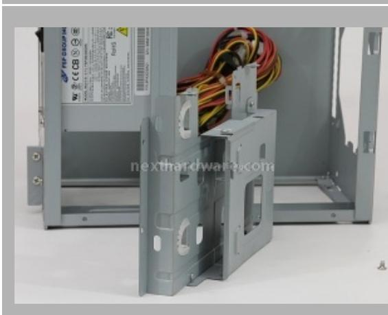
Interessante il cestello superiore, removibile svitando le 4 viti che lo ancorano alle traverse della parte alta, accoglie il lettore ottico slim, ed un hard disk da 2,5â€. Il vano per l'hard drive supporta anche i Western Digital Velociraptor, piú spessi del normale.
