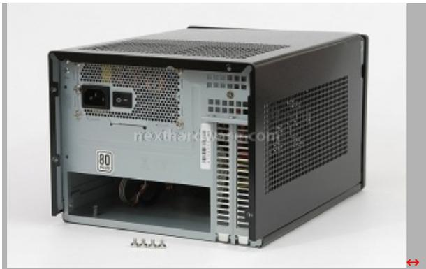
Procediamo quindi con la rimozione del "cover". In effetti Sugo SG05 non utilizza un "tetto" e pannelli laterali, bensì un pezzo unico di lamiera piegata.
