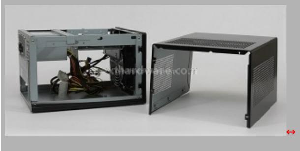
Una volta rimosse le viti, basta tirare verso di se la struttura e sollevarla verso l'alto per mettere a nudo lo "scheletro" di Sugo SG05.
