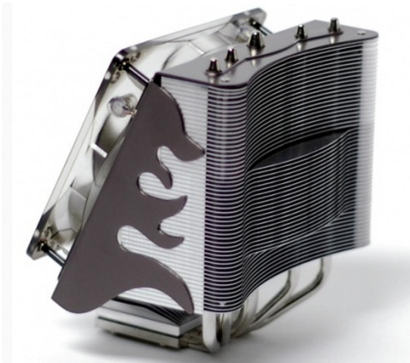
La nota società olandese Nexus Technology oggi ha presentato ufficialmente il suo ultimo dispositivo di raffreddamento per CPU, il VCT-9000. Le misure di questo dissipatore sono 133x118x154 mm e pesa 635 grammi, comprende cinque heatpipes, di cui una più centrale da 8 millimetri e altre quattro da 6 millimetri, tutte in rame placcato nickel e a diretto contatto con la cpu.
