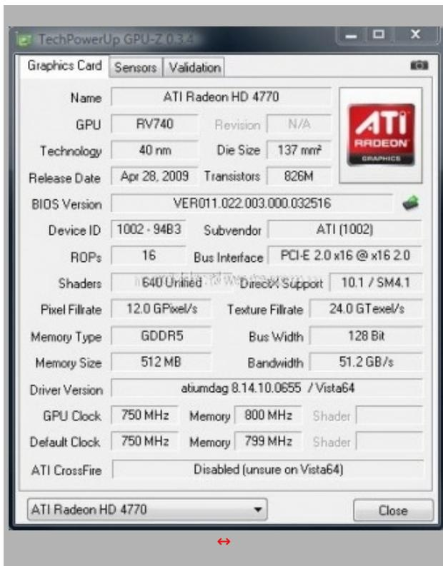
La HD4770 è equipaggiata con una GPU RV740, frutto di oltre un anno di sviluppo da parte di AMD e TSMC, fonderia dove la GPU viene materialmente costruita con l'innovativo processo produttivo a 40nm.
