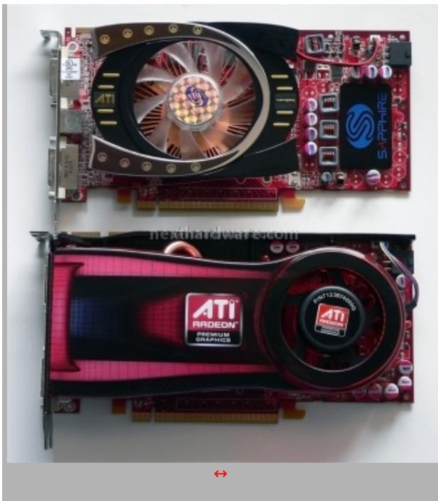
La Radeon HD4770 è stata distribuita alla stampa in un reference design differente rispetto a quanto sarà possibile trovare sul mercato, la scheda è infatti dotata di un PCB con più componenti discreti e un dissipatore simile a quello delle schede di fascia superiore HD4870/4890.
