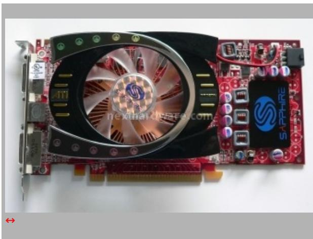
Sapphire, come la maggior parte dei produttori, ha scelto di personalizzare in modo minimo il design di produzione, applicando un dissipatore in alluminio sui mosfet con il logo della casa. Questa soluzione garantisce una minor temperatura del circuito di alimentazione a favore di una migliore gestione termica della scheda video.
