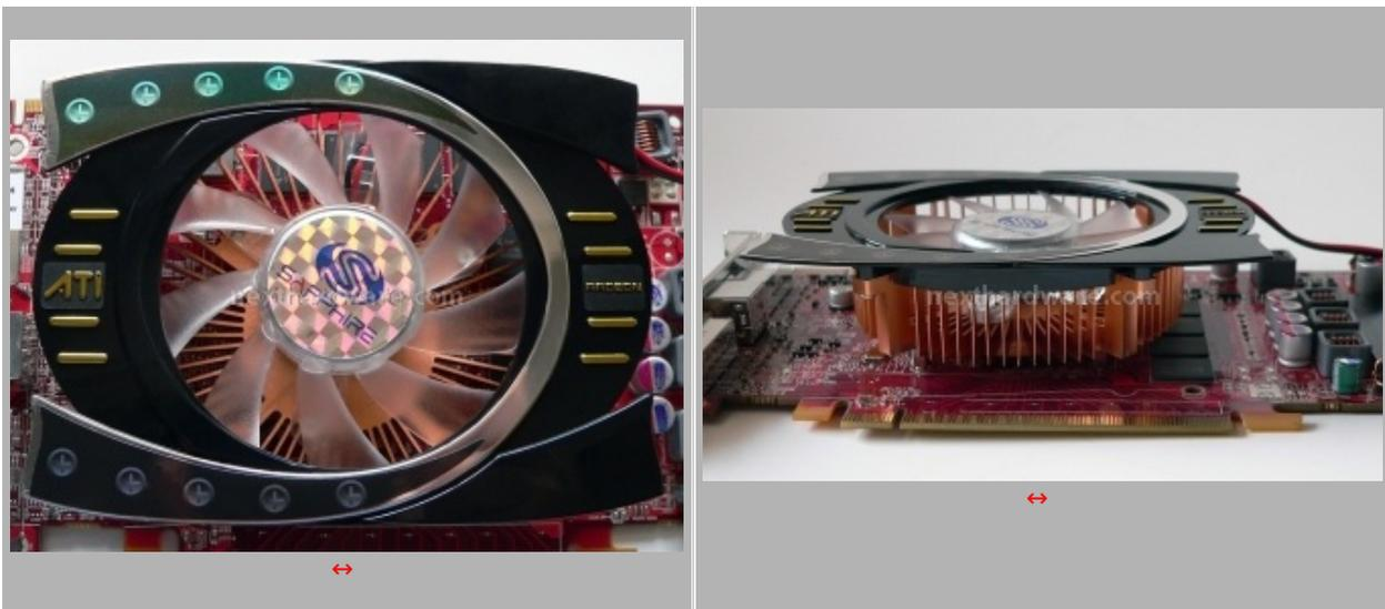
Il dissipatore utilizzato dalla HD4770 di Sapphire occupa 2 slot come la versione reference, ma non presenta alcun tunnel di espulsione dell'aria calda, favorendo un certo ristagno all'interno del case in caso di una non corretta areazione. La qualità dei materiali è buona e la ventola risulta poco rumorosa durante le normali condizioni di operatività.
