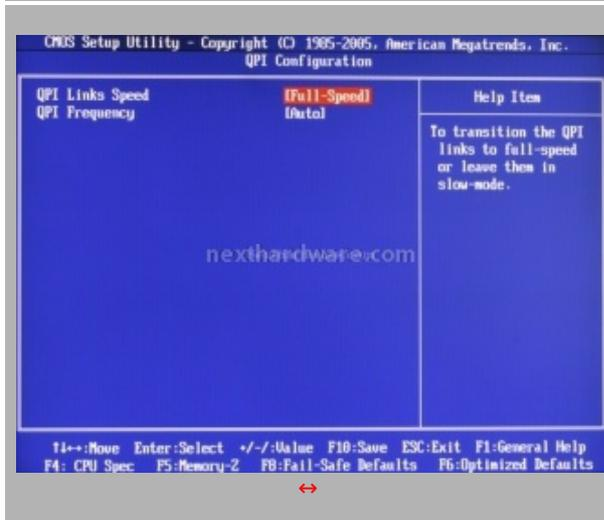
Si accede a questo sottomenù dalla voce "QPI Configuration", qui è possibile "esettare" la modalità del QPI in Full Speed o Low Mode, e la frequenza del QPI stesso. (immagine a sinistra)
