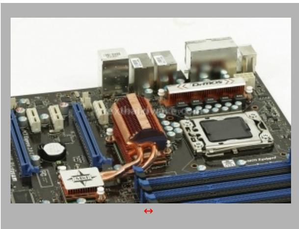
Curato ma essenziale il sistema di raffreddamento utilizzato su X58 Platinum. Da quel che possiamo notare, il cooling dei componenti si affida ad una soluzione completamente passiva. Tutto il "lavoro" è quindi affidato alla ventola del dissipatore CPU. Avremmo gradito una soluzione di continuità delle Heat Pipes in luogo dello "spezzato" scelto da MSI.
