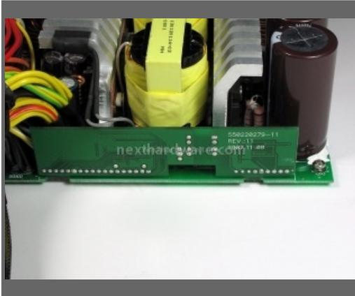
Questa è l'unica mini-board presente nell'alimentatore. Gestisce tutti i parametri di sicurezza dell'alimentatore e la sezione di termoregolazione della ventola.
