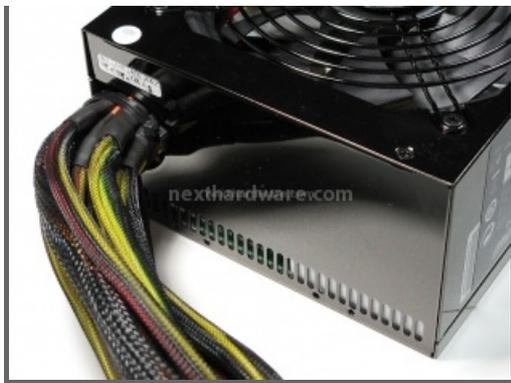
Come già detto altre volte, riteniamo che con le tecnologie attuali sia possibile non terminare lo sleaving dei cavi in corrispondenza della parte metallica del cabinet, e soprattutto, che ci sia modo di evitare che sia una fascetta ad occuparsi di tenere raccolta l'intera massa di cavi.
