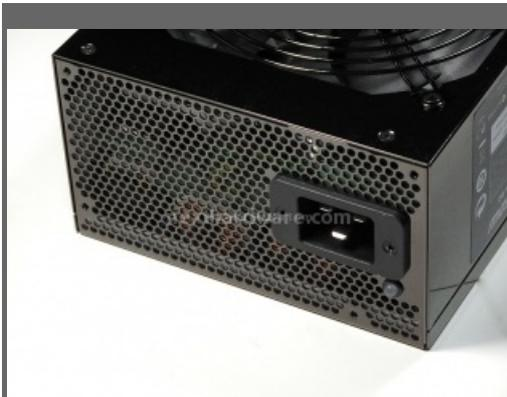
Lato posteriore, CoolerMaster ha scelto di utilizzare il plug di alimentazione oversize già visto in altri alimentatori.
