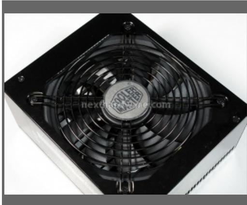
La ventola scelta da CoolerMaster per il raffreddamento dell'intera unità . 135 mm a detta del produttore da meno di 16dBa.
