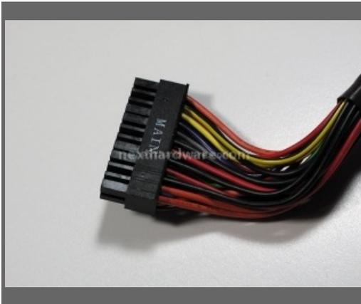
Cavo di alimentazione ATX 24pin
