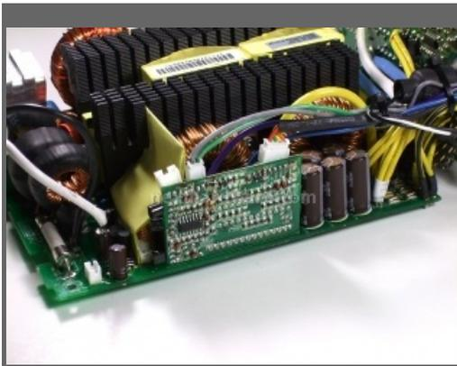
Lato corrente in uscita, come potete vedere dall'immagine c'è una grandissima concentrazione di cavi nel lato destro, tutte le uscite +12,0volt infatti sono in quel punto. Per garantire la massima stabilità, sono presenti 8 condensatori a basso ESR per un totale superiore a i 15000uF.
