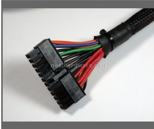
Cavo di alimentazione ATX 24pin
