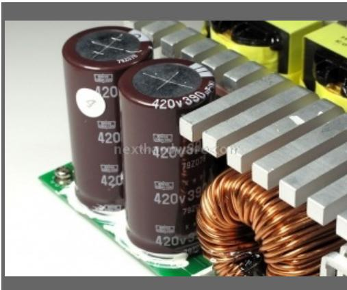
Due condensatori gemelli per la sezione corrente in ingresso.
