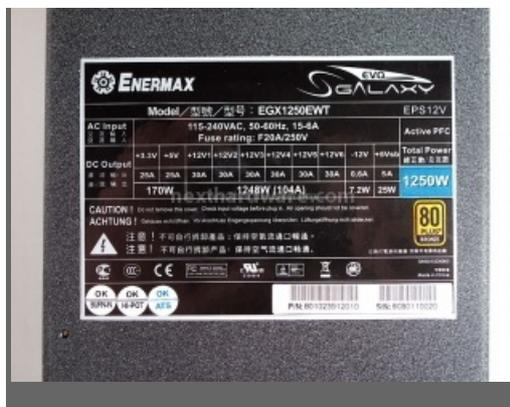
In questa immagine l'etichetta che riassume le caratteristiche salienti di questo prodotto. Notare come l'alimentatore sia in grado di erogare il 99% della potenza anche solo sulle linee 12volt.
