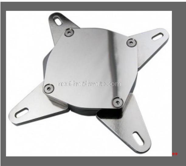
Koolance questa settimana inizierà la spedizione del suo ultimo waterblock, il CPU-360, compatibile con i socket Intel LGA 775/1156/1366 e AMD AM2/AM2+/AM3. Questo prodotto misura 12,5x12,5x1,5 cm, pesa 411 grammi e dispone di una base in rame e top in ottone uniti tramite guarnizione oring, i raccordi sono da 1/4". Il waterblock Koolance costerà 84,99 dollari e si prevede che sarà disponibile negli shop a partire dal 12 febbraio.
