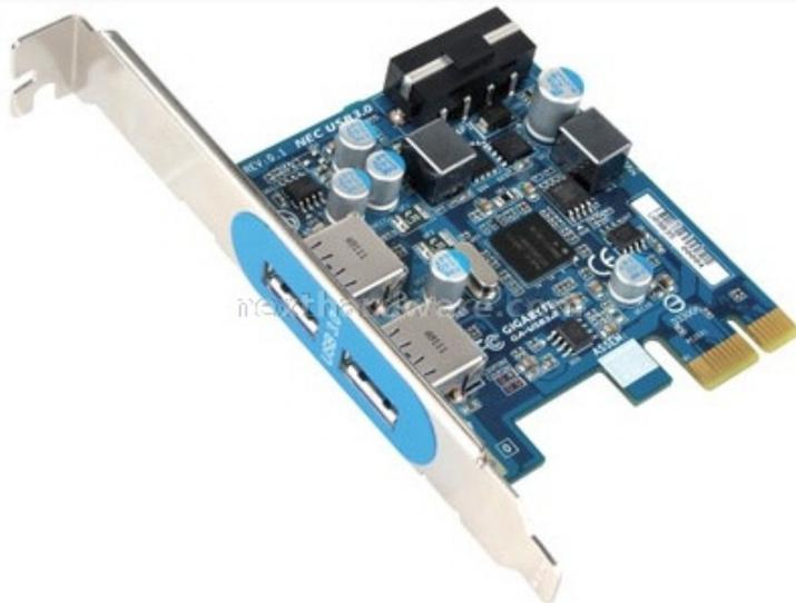
Gigabyte ha recentemente introdotto la GA-USB3.0, una scheda di espansione PCI-Express che fornisce ai meno recenti (ma anche attuali) PC due porte USB 3.0. Questa scheda PCI-Express usa un'interfaccia x1, ha due connettori USB 3.0, PCB 2 OZ di colore azzurro tipico di Gigabyte, e un connettore Molex che fornisce una quantità maggiore di energia (fino a tre volte) per i dispositivi collegati. La Gigabyte GA-USB3.0 è già disponibile e costa circa 31â,-.
