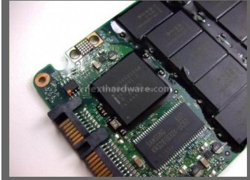
In primo piano i componenti fondamentali del SSDNow, da notare come venga utilizzato un tipico integrato RAM disposto in prossimità del controller. Sicuramente questo elemento viene utilizzato come cache e sarà uno degli elementi chiave del brevetto Intel, capace di abbassare il Write Amplification a solo 1,1x.
