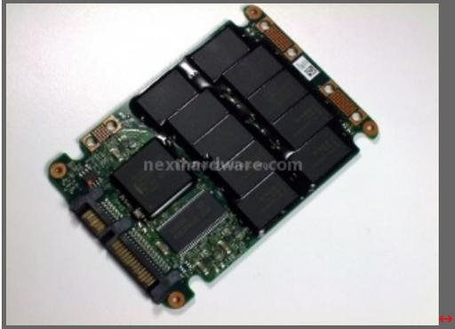
In queste foto le due faccie del Pcb, si nota in particolar modo come ogni chip sia immerso in una resina nera. Riteniamo che quest'ultima serva ad aumentare la rigidità del circuito. Osservando la disposizione dei chip sul pcb risulta subito chiaro come questi comunichino attraverso il controller a 10 canali.
