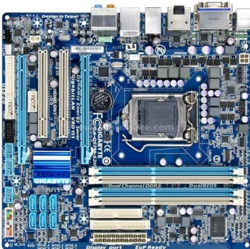
Il produttore taiwanese Gigabyte Technology, ha appena rivelato la GA-Q57M-S2H, la sua prima scheda madre basata sul chipset Intel Q57. Caratterizzata da un PCB blu, la nuova scheda micro ATX si avvale della tecnologia Dynamic Energy Saver 2, supporta i processori LGA 1156, e vanta quattro slot di memoria DDR3-1600, due slot PCI-Express x16 slot, Intel Active Management (una soluzione che consente la gestibilità da client remoto, della diagnostica ed il monitoraggio delle attività).
