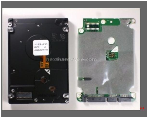
Rimosse altre 5 viti possiamo separare il corpo meccanico dalla logica elettronica, quest'ultima protetta da un sottile strato di materiale isolante.
