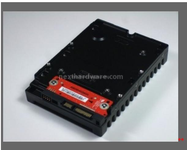
La struttura dissipante IcePack si occupa di ospitare il disco e le connessioni SATA posteriori
