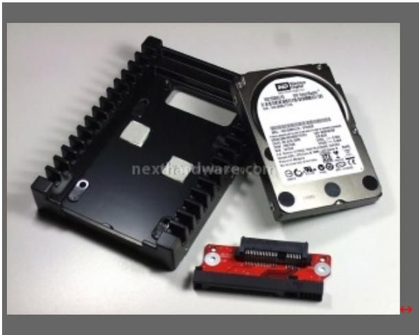
Rimosse le 4 viti che assicurano l'harddisk alla struttura possiamo disassemblare i vari componenti.
