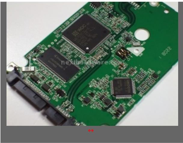
La logica di gestione del Velociraptor mostra una realizzazione impeccabile. Dall'immagine si notano subito le piste adibite al passaggio dei dati che partono dalla porta SATA per entrare nel controller e a loro volta per raggiungere le piazzole che andranno a contatto con il connettore della testina.
