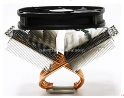
Scythe ha rilasciato il Grand Kama Cross, un nuovo dissipatore per cpu che misura 177x140x137mm.
