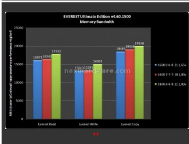
La banda aumenta in maniera costante all'innalzamento della frequenza e viene influenzata solo in minima parte dai timings. Infatti nelle due prove a DDR3-1600 MHz con CAS7 e CAS8 si vede come ci sia un incremento di banda abbastanza trascurabile.
